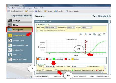
4. <u>Ajuste de threshold</u>: no menu esquerdo, escolher a opção "Analysis" > "Amplification Plot". No campo "Options" escolher um "Target" (alvo) de
