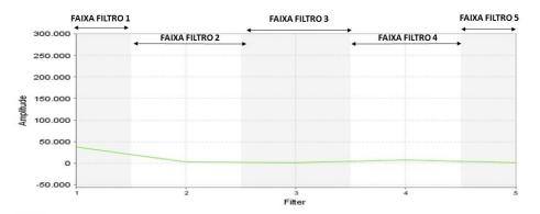
No menu esquerdo, escolher a opção "Analysis" > "Raw Data Plot". A amostra dúbia e o controle negativo deverão estar selecionados para comparação da fluorescência no filtro específico.
